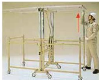
6 外脚の高低調整ピンを外し、外脚スライド脚の先端が天板の脚受けノブにはまるように合わせ高低調整ピンを戻します。(4本)
