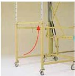
4 脚安定バーをセットしてください。 ※手摺を使用の場合は所定の位置に手摺をセットしてください。
