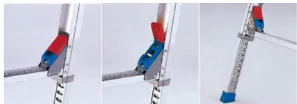
各伸縮脚は、25mmピッチで調節可能。凹凸のある場所でも天板を傾けずに作業できます。ロック操作部は安全カバーを採用。蓋が閉じられることでロック確認が行え、異物の侵入も防ぎます。
