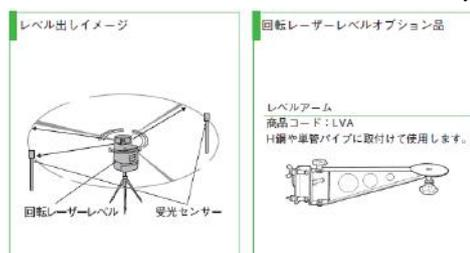
レーザー光と受光センサーでレベル出し作業が1人で行なえます。また、受光センサーを増やすことで多数点の同一レベルが一度に行なえます。
