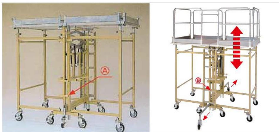
7 Aの昇降用バーとBの梯子の手前側を持ち、2人同時に持ち上げ、施工高に合わせて高さを調整して下さい。
