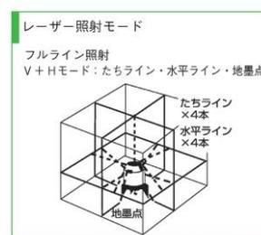
レーザー光が水平方向に360度射出しますので本体を設置し直す手間がありません。受光センサーを付属していますので、明るい場所での作業も可能としています。
