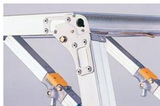
開脚状態で回転金具と固定金具が完全接触。突き出しピン方式だけでは解消が困難な金具部分のガタツキが大幅になくなりました。
