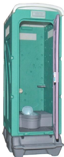
品番: AUG-1J+BC37N 品名: ペダル式軽水洗便槽付 重量: 103kg 清水容量: 60ℓ 便槽容量: 320ℓ
