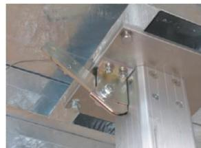
ワイヤー切断時だけでなく、ロックを掛けたまま本体を下げ、ワイヤーが緩んだ状態でロックを解除してしまった場合にも自動で落下防止。
