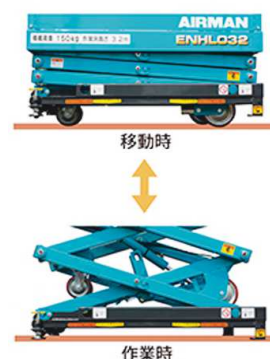
上昇時にアウトリガーが自動接地
