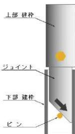
枠の接続はパネルジョイント構造。枠の先端が楔型で本体の揺れ軽減。連結もスムーズに行えます。
