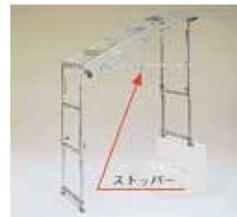
11 補強用伸縮バーのストッパーを解除します。
