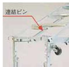
14 連結ピンで下のダンダンと連結します。
