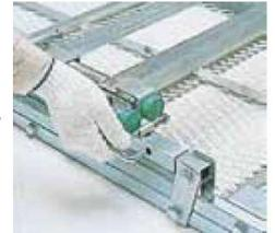
4 補強用伸縮バーのストッパーを解除します。
