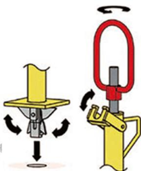
※覆工板メーカーによってパイプ受金具の向きが変わる場合があります。その場合、単管クランプにて手摺を取り付けて下さい。
