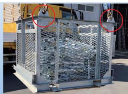
吊り上げます。(吊りピース穴径=φ40)
