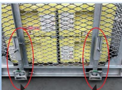
次に抜け止めピンをセットします。
