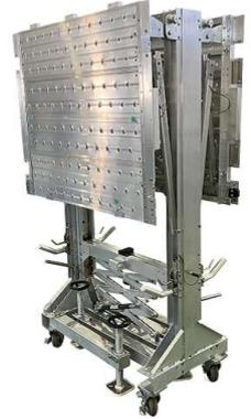
ガスダンパー搭載で伸縮を補助
